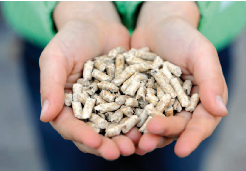
Holzpellets werden aus Säge- und Hobelspänen gepresst.
