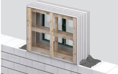
1. Fenster satt in Mörtel setzen.
