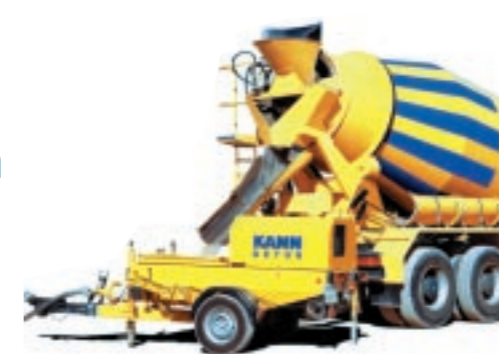
KANN Fahrmischer mit Estrichförderpumpe (für Fließestriche, Porenleichtbetone und Flüssigbaustoffe).
